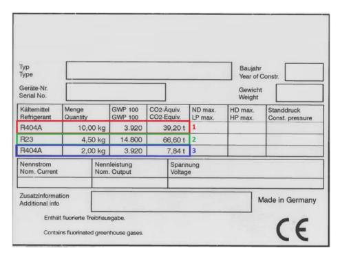
Abb. 1: Typenschild einer Umweltsimulationsanlage
